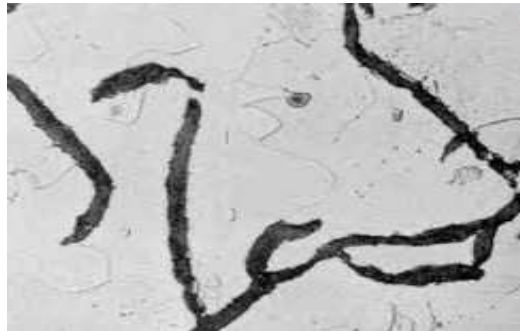
7.14. ábra Lemezes grafít a szürke öntöttvasban
